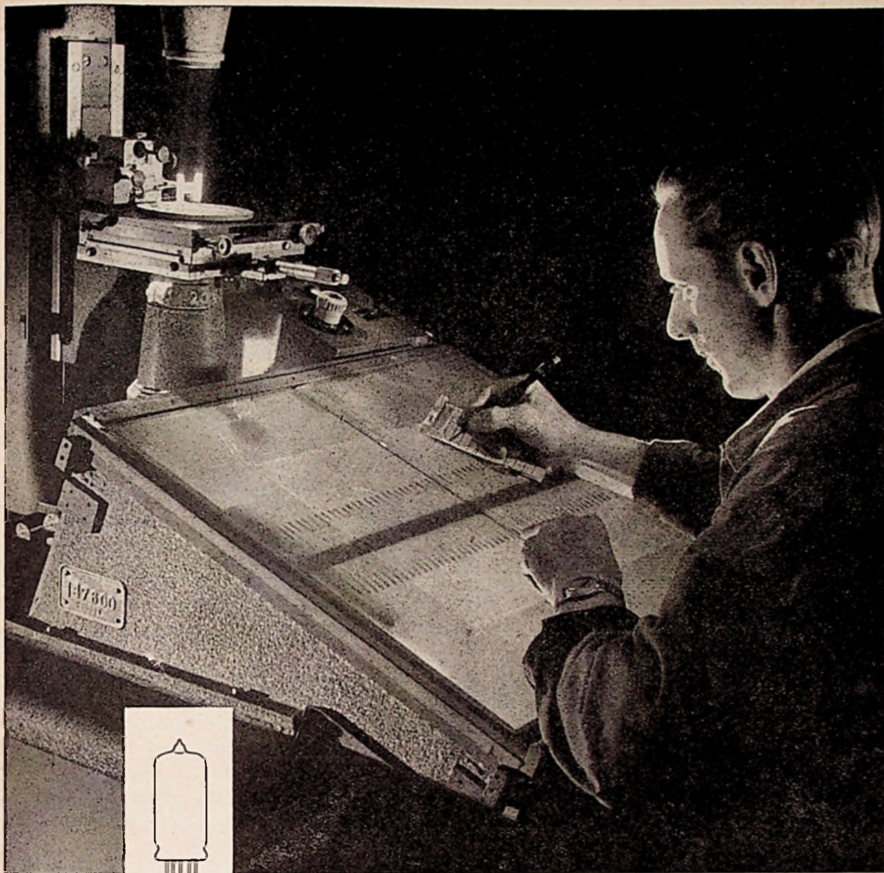
Controle van een rooster door projectie op een vergrote tekening.
